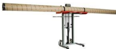
Levanta bobinas hasta 150 cm de hasta 5 metros de ancho
